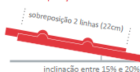
Figura 10 - Linhas a sobrepor em função da inclinação
