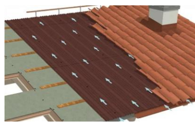
Figura 24 - Caixa de ar e ventilação
